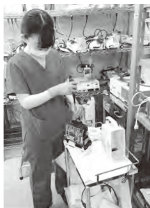
輸液ポンプ外装交換 (修理対応)
