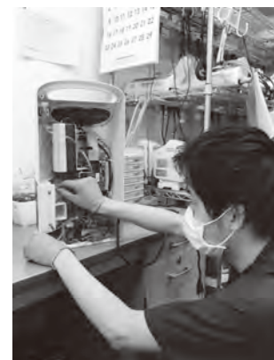
低圧持続吸引器動作不良 (修理)
